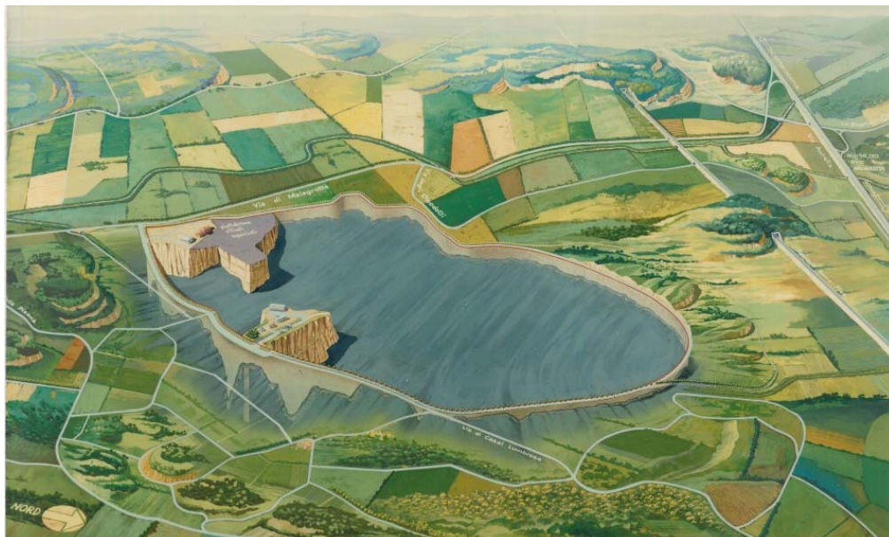
Fig1- Discarica di Malagrotta. Visione prospettica del diaframma plastico. Nella parte Est, è visibile l'andamento del top delle argille di base, e l'articolazione del diaframma plastico. (From Roma Capitale (2017, modificato).
